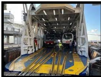
arrivano direttamente a Palermo e a Siracusa! L'imbarco dei treni avviene dalla prua delle navi, che viene aperta quando la nave si trova in prossimità dell'invasatura di Villa San Giovanni e sulla quale viene strettamente connesso un ponte munito di binari, manovrato mediante dispositivi di sollevamento e abbassamento dopo che la nave è stata correttamente ormeggiata e assicurata
